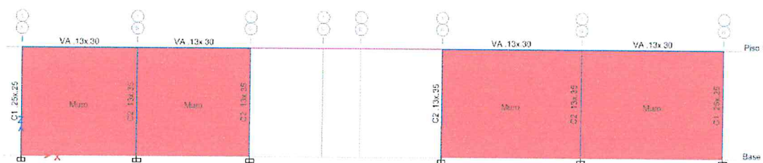
Fig. 14. Vista en perfil– eje 1 de la estructura del colegio.
