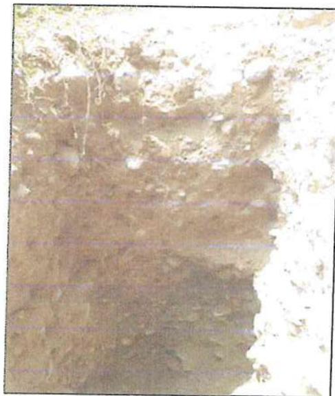
imagen Nº 43: Suelos heterogéneos de naturaleza gravo arenosa con limos y en la parte superficial rellenos antrópicos<sup>89</sup>
