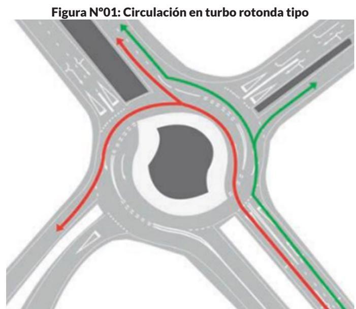
Figura N°01: Circulación en turbo rotonda tipo
