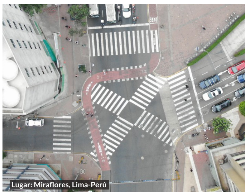
Imagen N°23: Funcionamiento de cruceros diagonales
