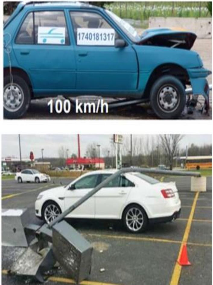
**Ilustración 15: Comparación de colisión contra poste rígido y poste EN 12767.
