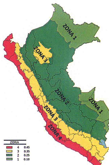
Fig. 03. Zonas sísmicas del Perú
