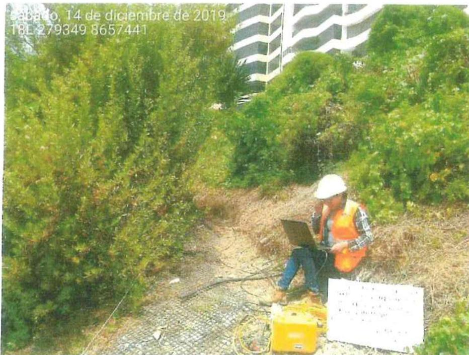
Fotografía N° 8 Desarrollo de la línea sísmica 02 y el ensayo MASW 4
