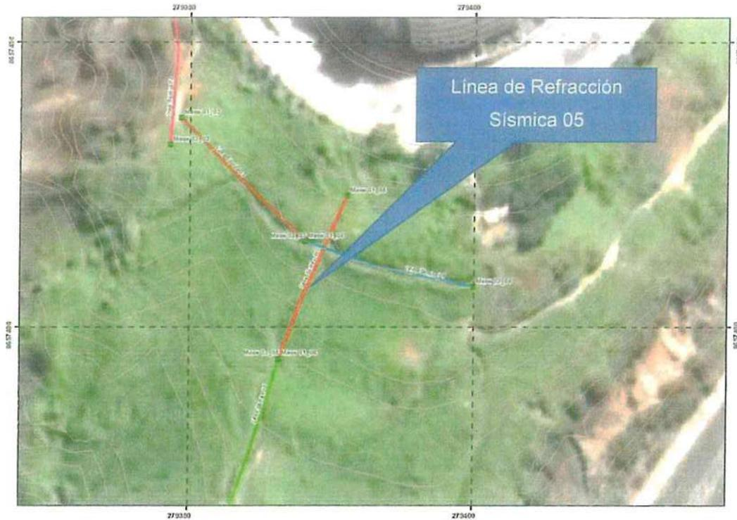
Según la estratigrafía determinada se tiene la presencia de dos estratos según el resultado de las dromocronas, el primer estrato corresponde a suelo de cobertura con velocidades de ondas P que varían desde 265 a 340 m/s y está asociado a arenas sueltas, este estrato estaría abarcando una profundidad desde la superficie hasta 2 metros aproximadamente.
