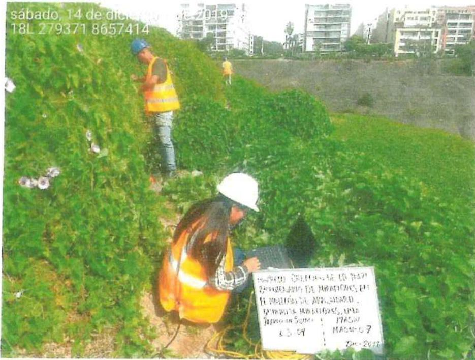
Fotografía N° 12 Desarrollo de la línea sísmica 04 y el ensayo MASW 8
