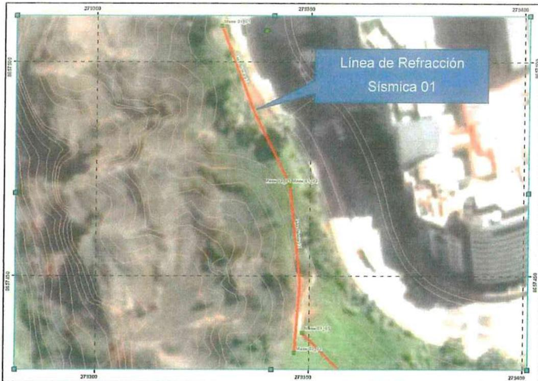
Según la estratigrafía determinada se tiene la presencia de dos estratos según el resultado de las dromocronas, el primer estrato corresponde a suelo de cobertura con velocidades de ondas P que varían desde 338 a 464 m/s y está asociado a arenas sueltas, este estrato estaría abarcando una profundidad desde la superficie hasta 4 metros aproximadamente.
