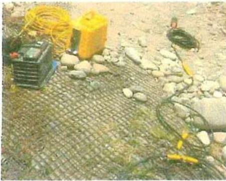
También conocido como cable conector de geófonos, la regla general es que la longitud extendida del cable conector de geófonos sea 1.5 a 2.5 veces la profundidad de investigación. Por ejemplo, si la profundidad de investigación es de 25m a 30 m, con un sismógrafo de 24 canales, la separación entre los geófonos deberá de ser de 1.5 m aproximadamente.
