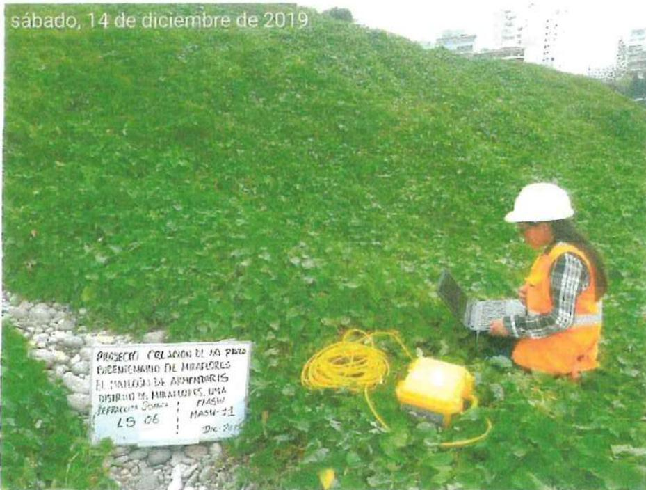
Fotografía N° 16 Desarrollo de la línea sísmica 06 y el ensayo MASW 12
