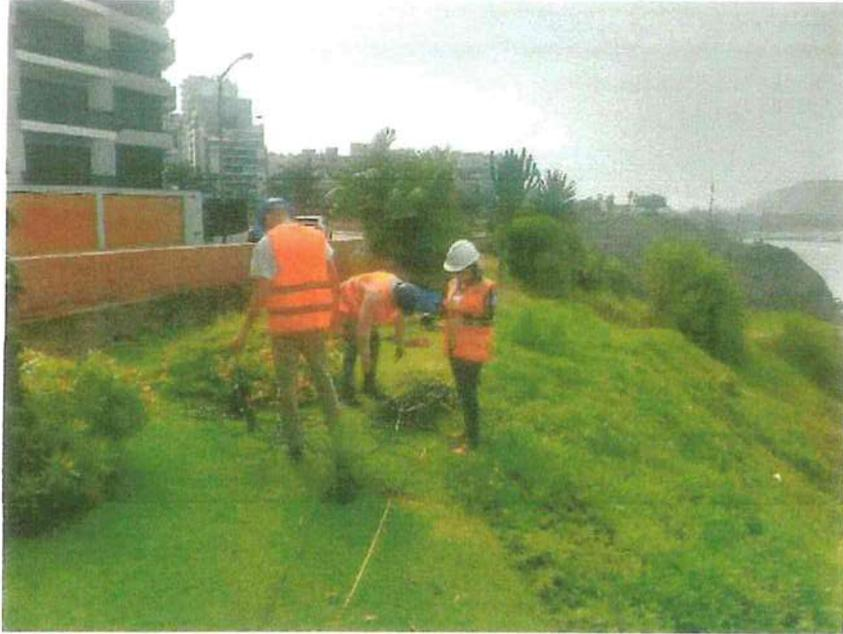
Fotografía N° 2 Ejecución de golpe de martillo para refracción sísmica
