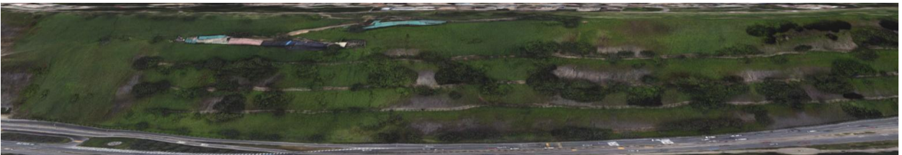
Figura 67. Trabajo de perfilado de talud con vegetación y zanjas de infiltración. Fuente Google Earth
