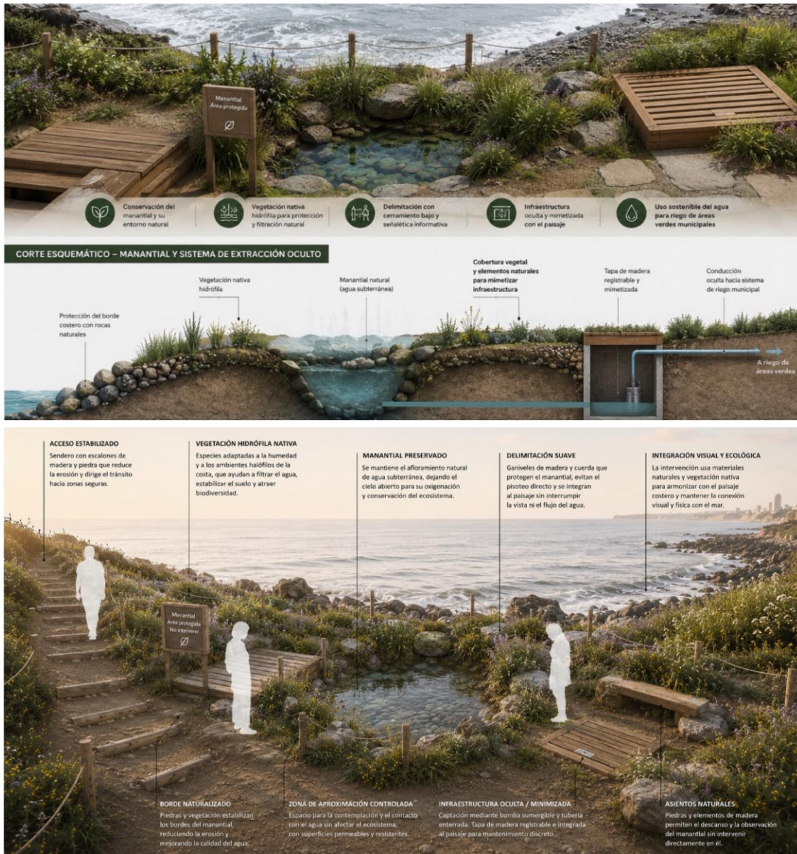
Figura 9. Manantial La Estrella: protección del afloramiento e integración condicionada de infraestructura de aprovechamiento hídrico. Elaboración: Equipo técnico
