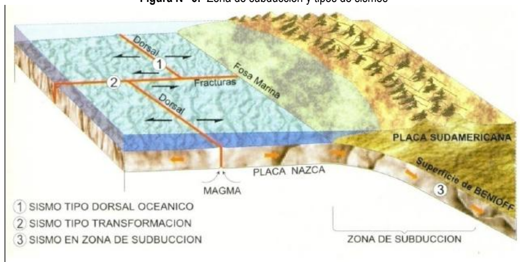
Figura N° 6: Zona de subducción y tipos de sismos
