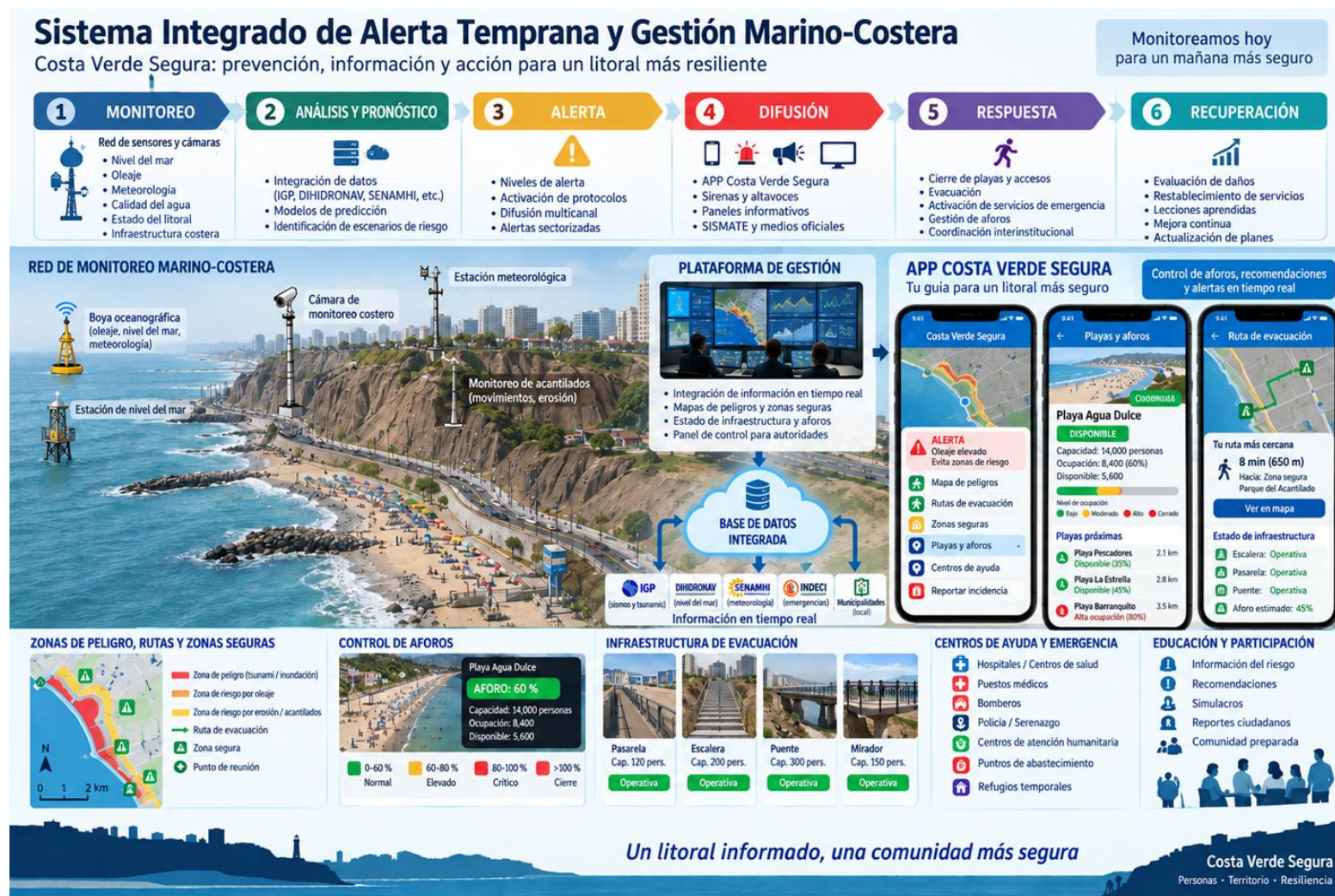
Figura N° 14: Arquitectura y Componentes del Sistema Integrado de Alerta Temprana y Gestión Marino-Costera (SIAT-MC-CV)
