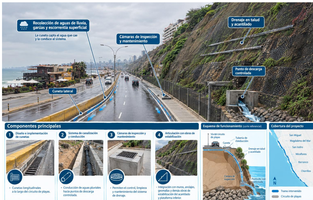
Figura N° 49: Proyecto de Drenaje Pluvial
