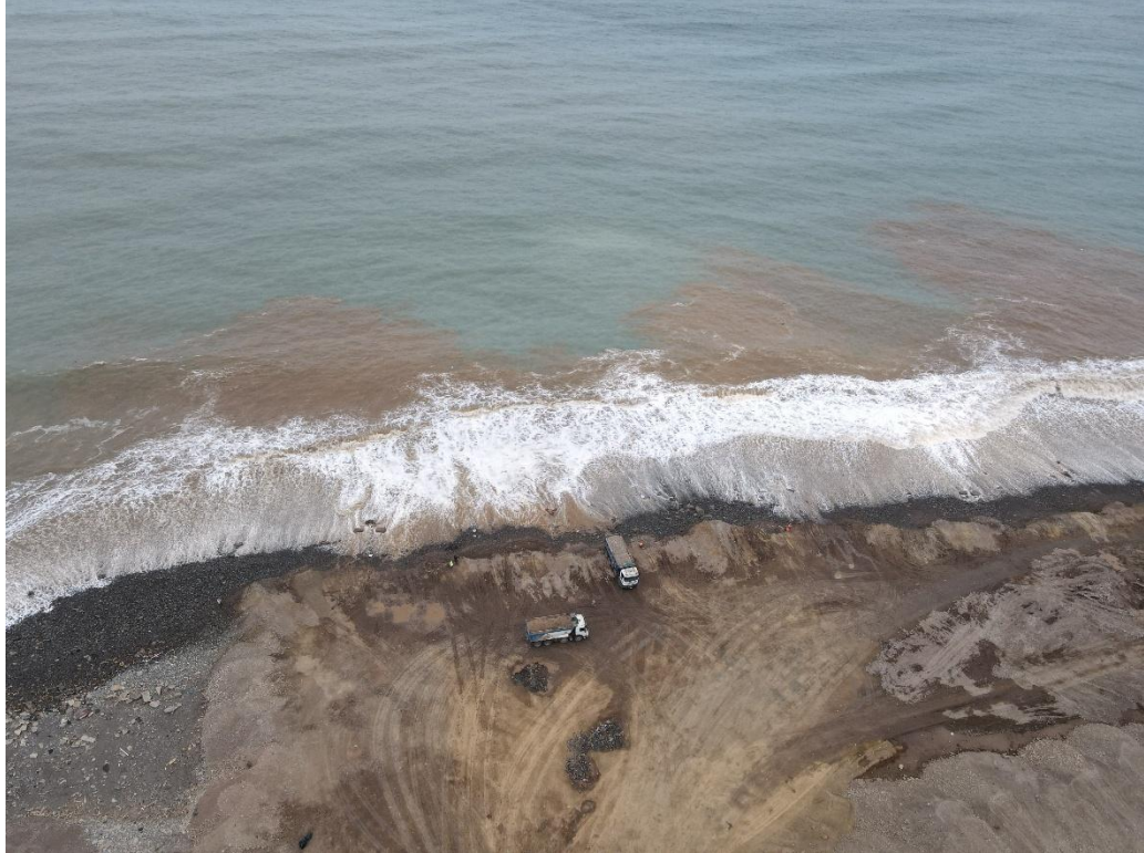
Imagen 25 Afectación de la turbidez por erosión de material de disposición
