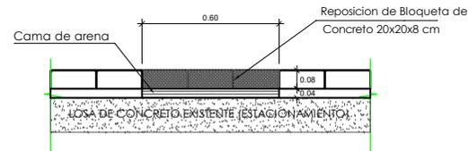
**DETALLE DE REPOSICION DE BLOQUETA EN VEREDA SOBRE LOSA DE ESTACIONAMIENTO (TIPO 2)**
