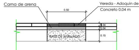
**DETALLE DE INSTALACION DE VEREDA CON ADOQUIN (TIPO 1)**
