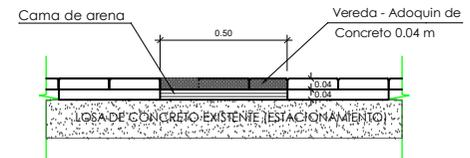
**DETALLE DE INSTALACION DE VEREDA CON ADOQUIN (TIPO 2)**
