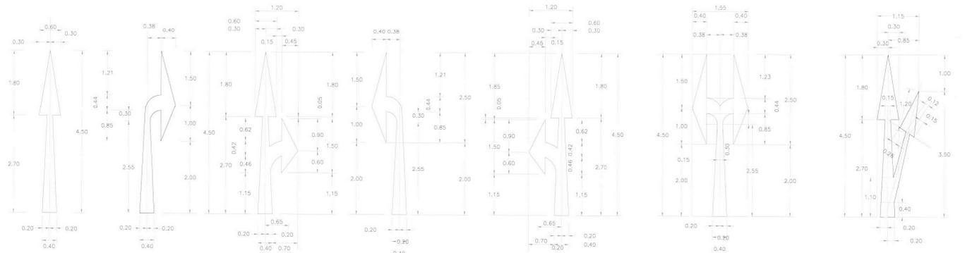
**SIGA ADELANTE**      **VOLTEE A LA DERECHA**      **SIGA ADELANTE O VOLTEE A LA DERECHA**      **VOLTEE A LA IZQUIERDA**      **SIGA ADELANTE O VOLTEE A LA IZQUIERDA**      **FLECHA EN PAVIMENTO CON DOS DIRECCIONES**      **FLECHA EN PAVIMENTO INCLUYE DESVIACIONES**
